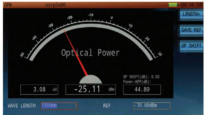
Figure 26: Optical Power Meter
